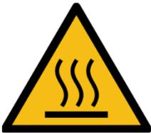
**Surface chaudes** : surfaces avec une température élevée pouvant conduire à de graves brûlures.
